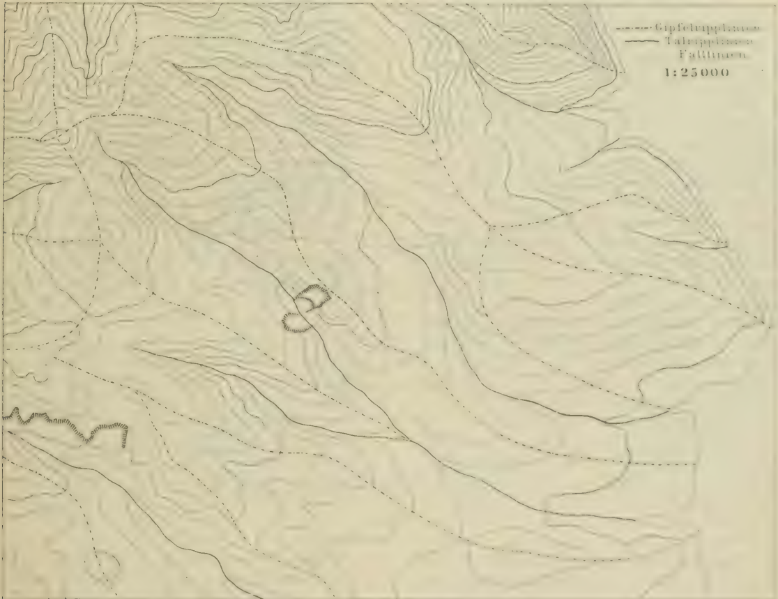
Fig. 43: Eintragung der Geripp- und Falllinien in eine Höhenschichtenkarte
